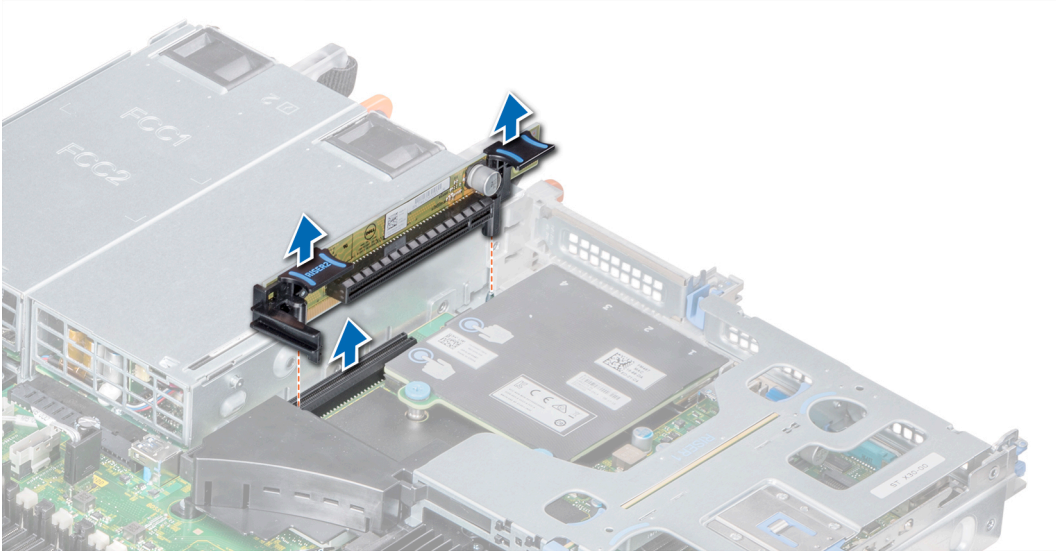
Rakam 36. Genişletme yükseltici 2A'yı çıkarma
